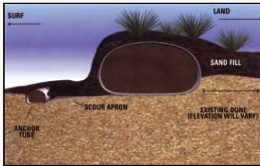
Sezione di un intervento di ricostruzione del nucleo di una duna in sabbia mediante l'inserimento di un TenCate Geotube®
