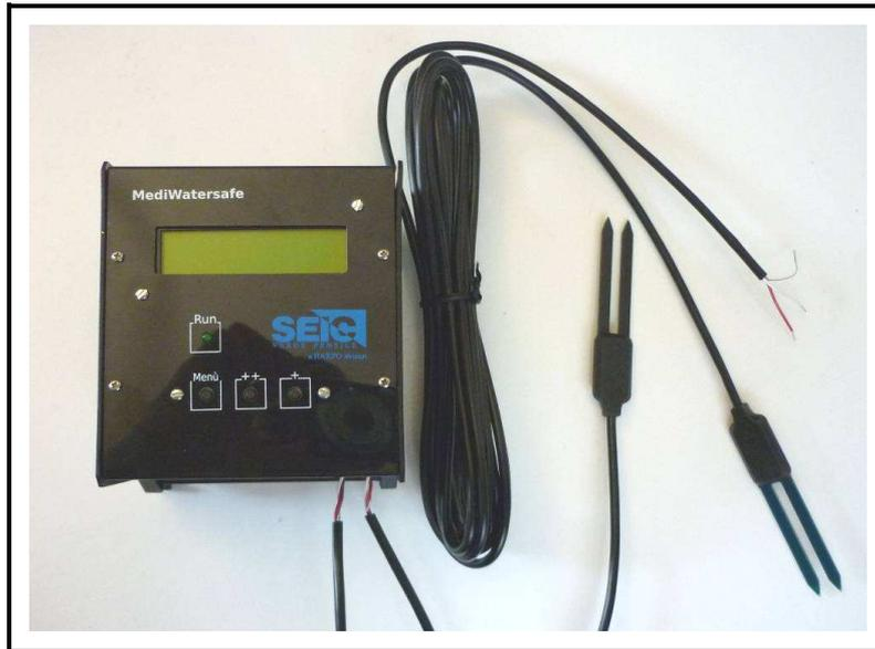
Fig: corpo centrale del Medi WaterSafe connesso ai sensori di potenziale idrico. Sul lato superiore si rinvencono i contatti per l'alimentazione da rete elettrica e le connessioni per la scheda periferica per il controllo delle elettrovalvole.
