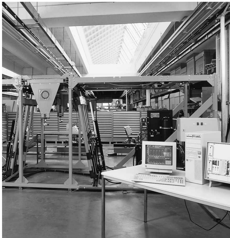
Simulatore del carico del vento controllato dal computer
